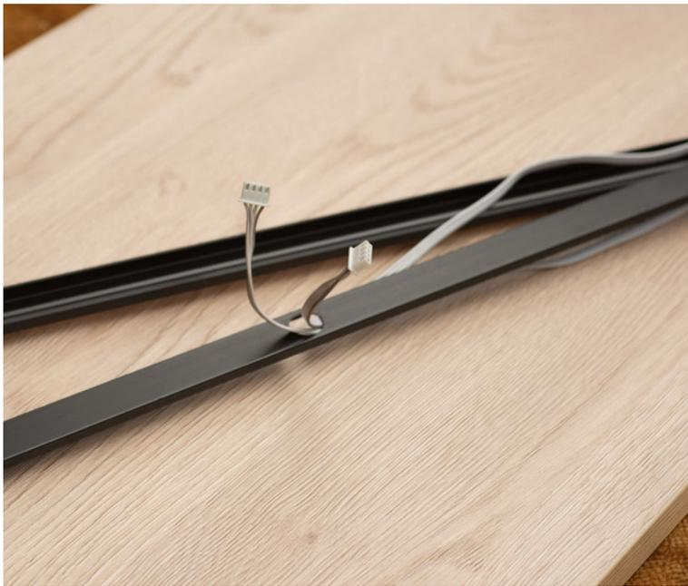
Öffne die Kappe vom schwarzen Kanal. Führe die LED-Kabel durch den schwarzen Kanal, so dass die Enden durch die mittige Bohrung der Kappe geführt werden. Lege die Kabel in den Kanal und schließe die Kappe. Klebe den Kanal mit dem doppelseitigen Klebeband an der Unterseite gerade unter Deinen Tisch.\*
