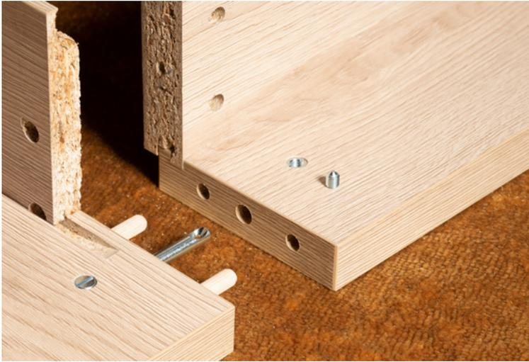
Setze das offene Gehäuse in das runde Bohrloch des zweiten Schenkels ein. Achte darauf, dass der Schlitz möglichst gerade liegt, parallel zur Außenkante. Drücke das Gehäuse in die Bohrung hinein.
