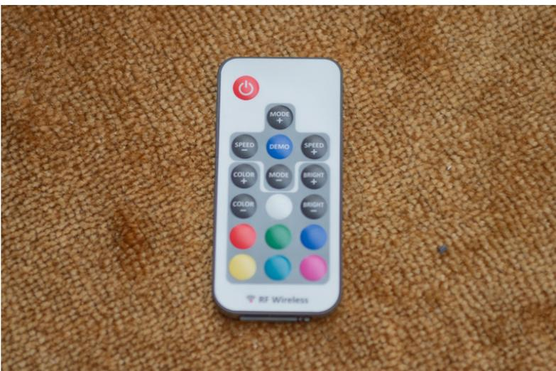
Mit dieser Fernbedienung steuerst du alle LED-Funktionen: Farben, Farbwechsel, Helligkeit und Geschwindigkeit des Farbwechsel können beeinflusst werden. Beachte bitte die Gebrauchsanweisung.\*
