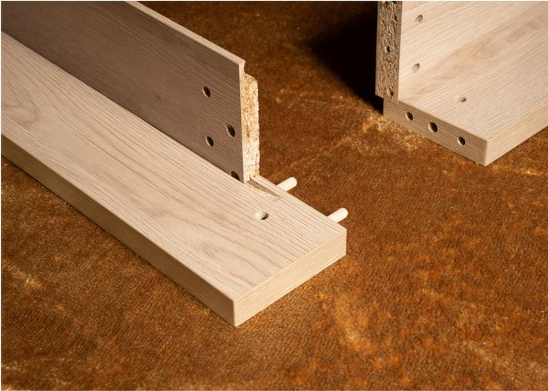
Setze zwei Dübel in die vorgebohrten Löcher an der Querseite ein.
