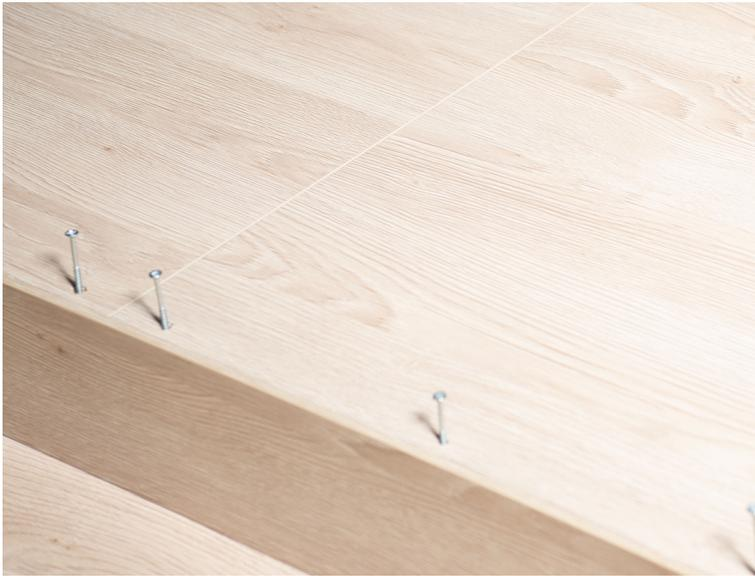
Lege die Kreuzschlitz-Schrauben in die Bohrungen und schraube die Bodenplatte fest, am besten mit Akkuschauber.
