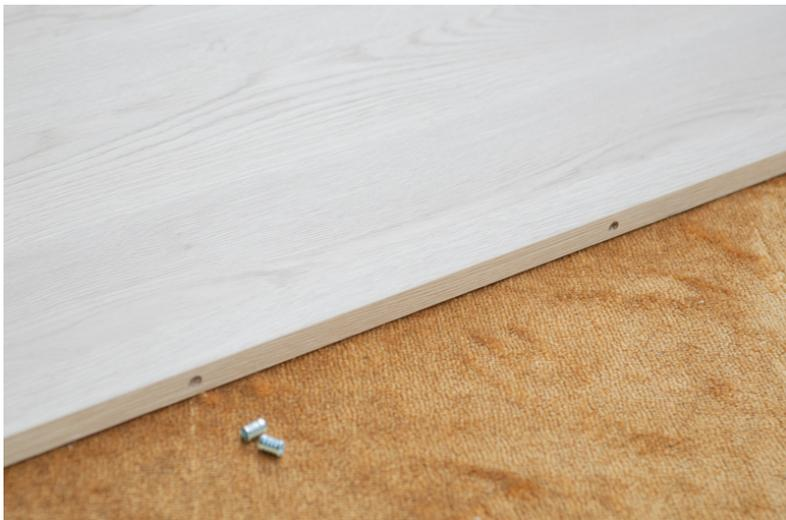
Achte darauf, dass Du bei den verschiedenen Abdeckplatten immer passende Paare einsetzt, so dass die Verbinder ineinander greifen.
