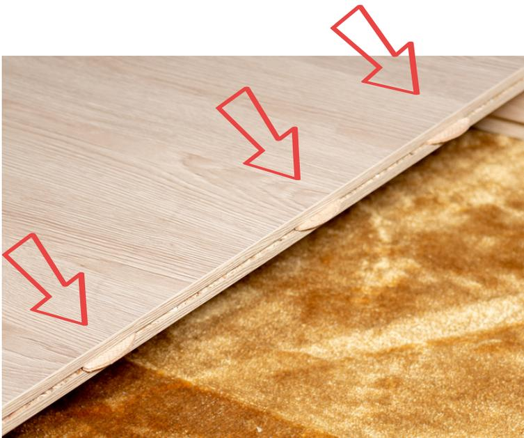
Lege die fünf Lamello-Verbinder in die Nut ein und verteile sie auf der Breite gleichmäßig. Schiebe die zweite Bodenplatte auf die Lamellos und drücke die Bodenplatte in den Rahmen. Es ist bewußt sehr eng.
