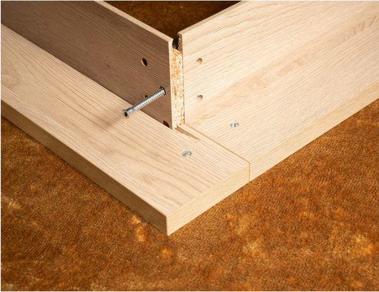
Verbinde die Ecken mit der Verbindungsschraube. Ziehe die Schraube fest an, am besten mit einem Akkuschauber.
